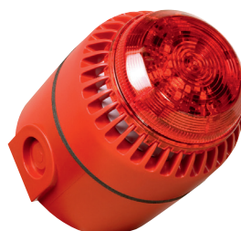
FLASHNI optisch-akustischer Signalgeber · IP65 · 98 dB (A) bei DIN-Ton · Xenon-Blitz
